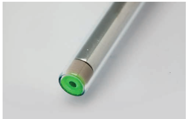
Grünes Fluorophor an der Spitze einer ersetzbaren Glasröhre
