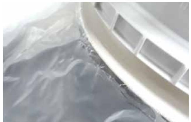
Abbildung 16: Kritische Überdehnung der Folie an der Kante des Anschlusses durch Positionierung auf der HDPE-Seite und/oder zu steile Vakuumrampe
