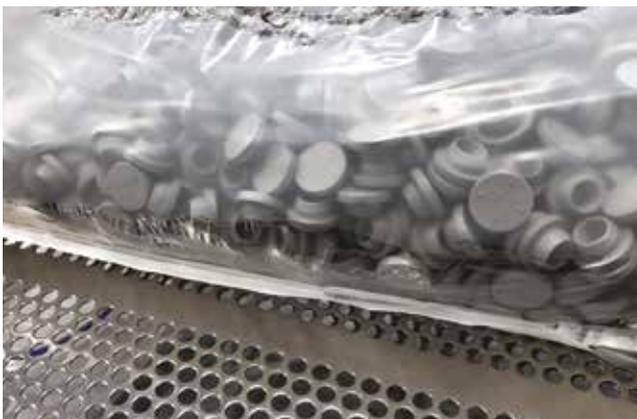
Abbildung 15: Kritische Überdehnung der Folie aufgrund von übermäßiger Befüllung des Beutels und/oder zu steiler Vakuumrampe
