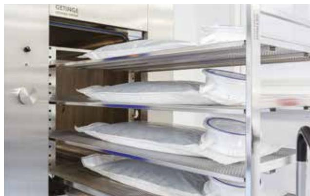
Abbildung 3: Ein DPTE-BetaBag® liegt sterilisationsbereit in einem Geringe GE6913 Sterilisator
