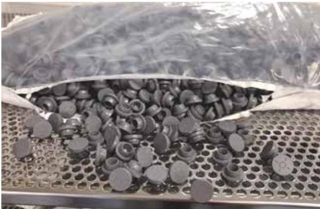
Abbildung 13: Eine Schweißnaht am Beutel ist aufgrund von übermäßiger Befüllung geplatzt.
