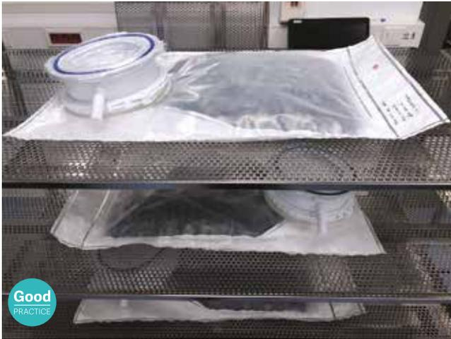
Abbildung 8: Korrekte Platzierung eines DPTE-BetaBag®-Tyvek®
