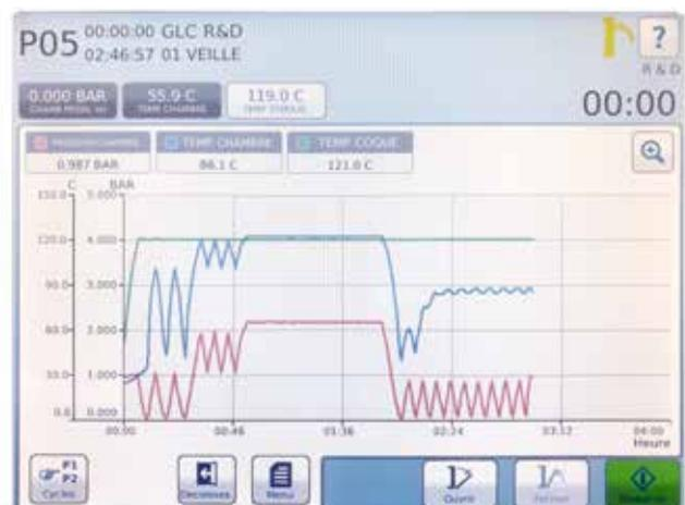
Abbildung 10: Darstellung der Druck- und Temperaturentwicklung in der Sterilisatorkammer
