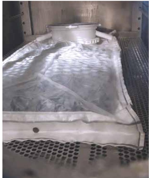
Abbildung 12: Entlüfteter Beutel bei Druckerhöhung
