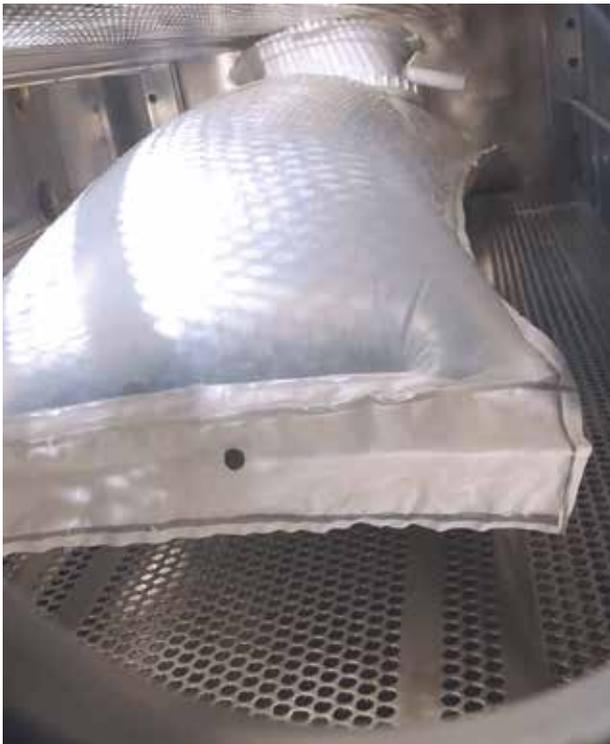
Abbildung 11: Aufblasen bei Druckabfall. Die Abbildung zeigt den Kontakt zwischen der DPTE®-Beta-Komponente und dem darüberliegenden Regalboden
