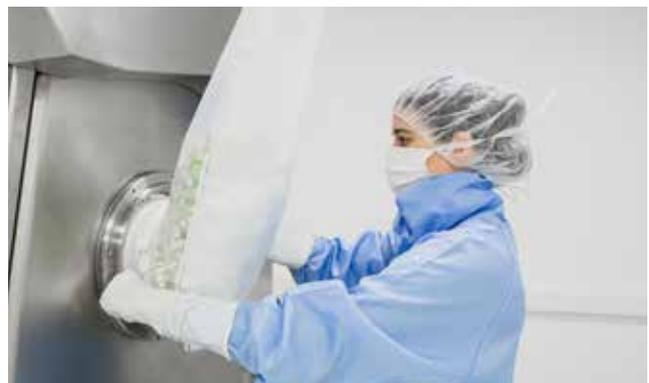
Abbildung 2: Ein DPTE-BetaBag<sup>®</sup>-Tyvek<sup>®</sup> Ø 190 ist an einen DPTE<sup>®</sup>-Alpha-Port angedockt
