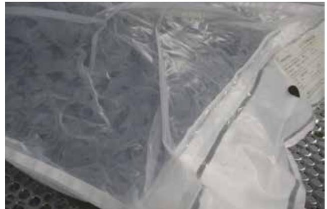
Abbildung 14: Außen- und Innenbeutel des DPTE-BetaBag® Doppelbeutels sind durch partielles Schmelzen der Folie verklebt (zu hohe Temperatur)
