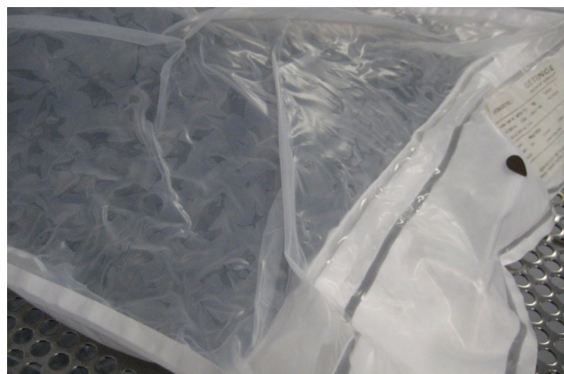
Illustration 14 : Sacs extérieur et intérieur du double sac DPTE-BetaBag®, collés l'un à l'autre en raison de la fusion partielle du film (température excessive)
