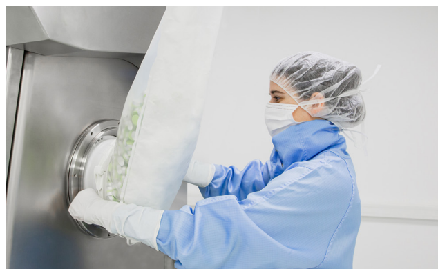
Illustration 2 : DPTE-BetaBag® Tyvek® Ø190 amarrés à un port DPTE® alpha
