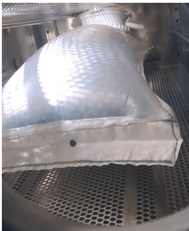
Illustration 11 : Gonflement pendant une baisse de pression. L'image montre le contact entre la partie DPTE® bêta et la tablette située au-dessus.
