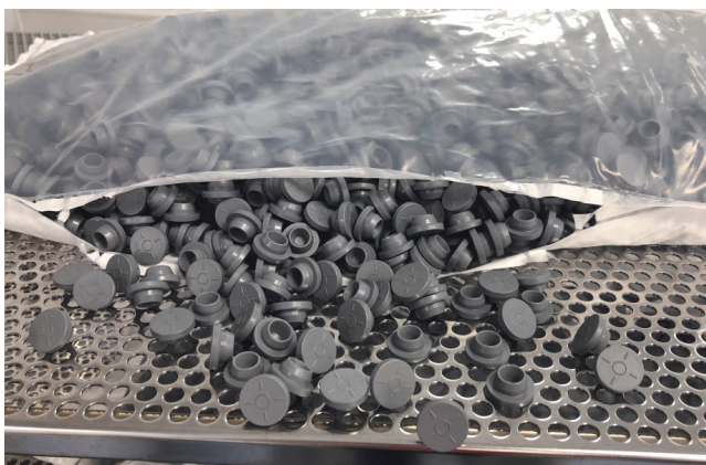
Illustration 13 : La soudure du sac s'est décollée en raison de la surcharge du sac
