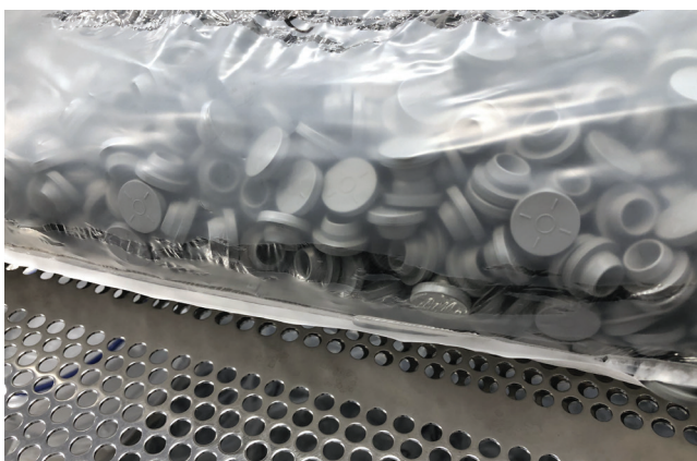
Illustration 15 : Allongement critique du film dû à la surcharge du sac et/ou à une rampe de vide excessive
