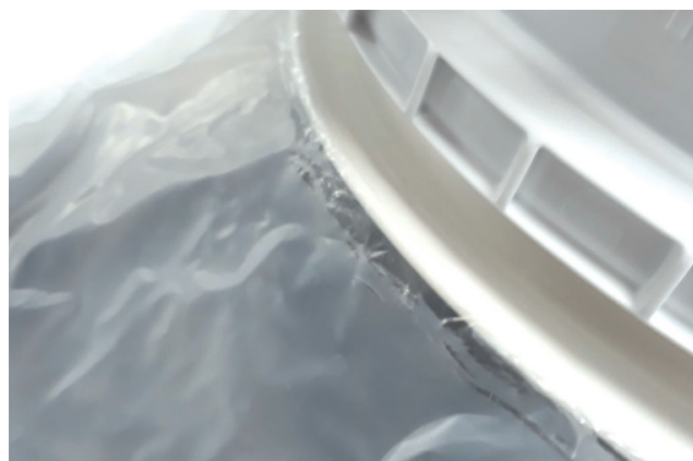
Illustration 16 : Allongement critique du film au niveau du bord du connecteur en raison du positionnement côté PEHD et/ou d'une rampe de vide excessive
