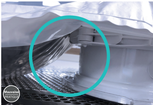
Illustration 9 : Contraintes sur le film de PEHD
