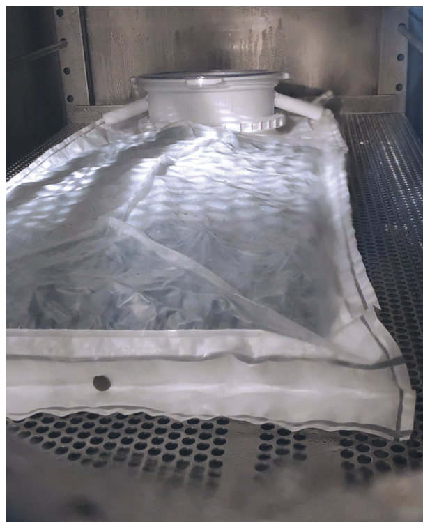
Illustration 12 : Sac dégonflé pendant la hausse de pression
