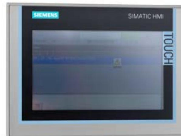
Le système de contrôle Siemens - Simatic (plateforme S7) intègre une interface tactile intuitive (IHM) qui propose des rapports, des options de commande et une surveillance du système en temps réel.
