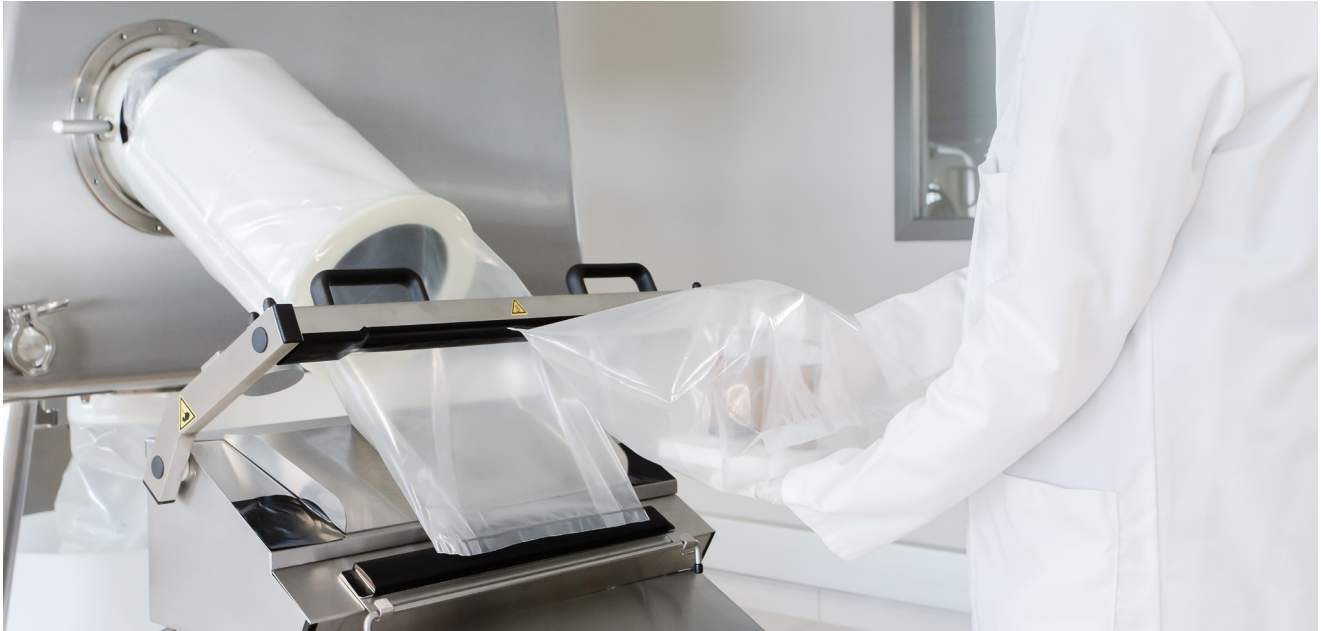
DPTE® Tubing avec thermoscelleuse pour le retrait des articles de la zone stérile
