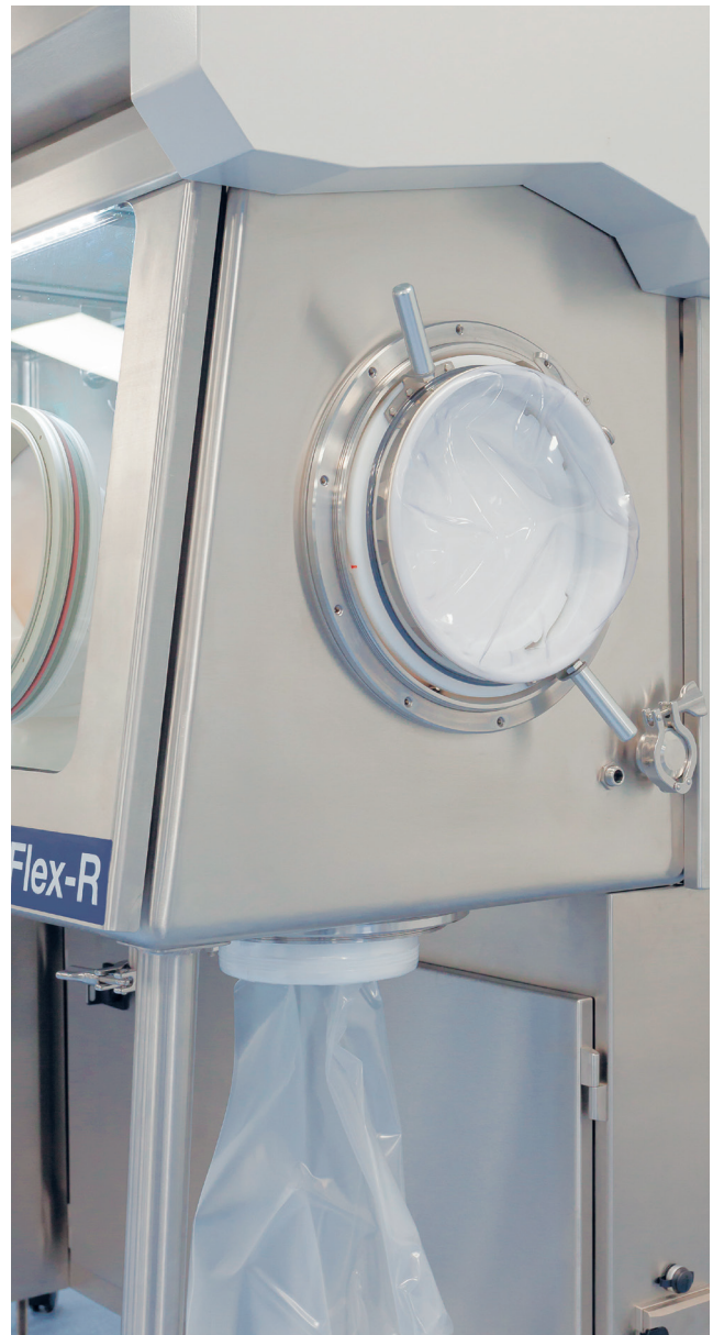
Retrait des déchets d'un isolateur à l'aide d'un DPTE-BetaBag®
