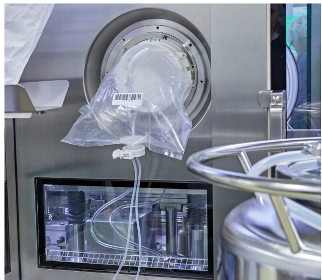
Transfert de liquide à l'aide du système DPTE® (avec l'aimable autorisation d'Octapharma)
