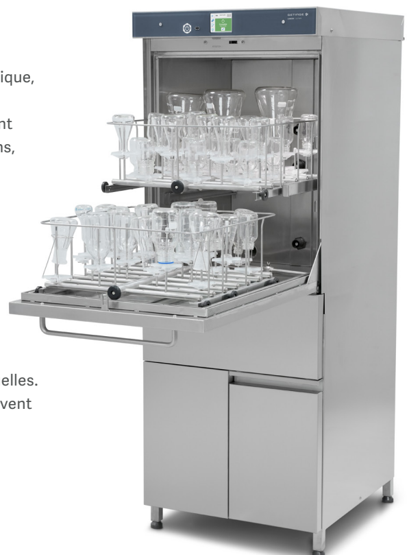
Laveur de matériel de laboratoire à chargement ergonomique Getinge Lancer Ultima (modèle 1300 LX) présenté avec deux paniers à injecteurs, vendus séparément.
