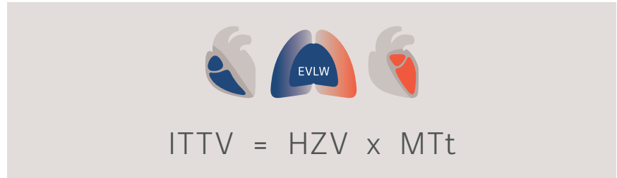
Schema und Berechnung des intrathorakalen Thermovolumens (ITTV)
