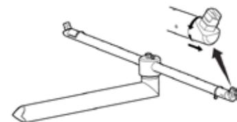
Bras de lavage et embouts démontables sans outils pour faciliter le nettoyage.
