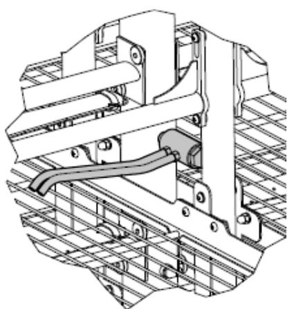
Pour des connexions corps creux supplémentaires, il est possible d'utiliser des supports 2 tuyaux silicone (50 mm) en complément.
