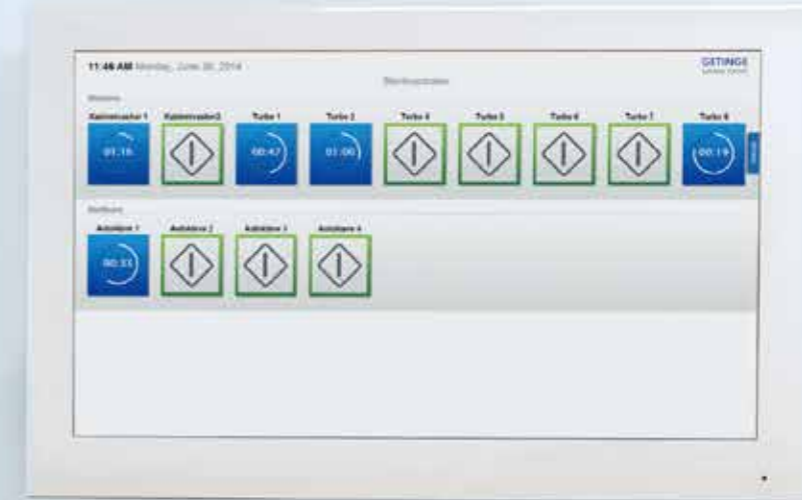
在线监视屏上显示清晰有序的信息，可查看设备当前状态，无需查看电脑或灭菌器即可完全掌控剩余过程时间、警报与警告。
